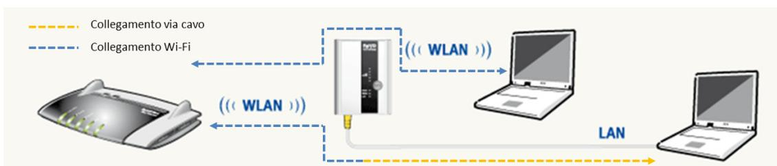
Nel secondo caso **(b)**, il collegamento tramite porta LAN è utilizzato per connettere il Repeater 300E all'access gateway, offrendo così la funzione di vero e proprio punto di accesso alla rete senza fili.
