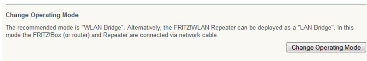
A questo punto, si può selezionare la modalità operativa: per funzionare da Access Point, la scelta dovrà ricadere sull'opzione "LAN Bridge"
