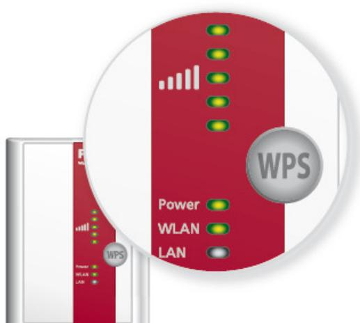
*Per ripristinare il Repeater 300E alla configurazione di fabbrica (ad esempio per riutilizzarlo con la sua funzione più tradizionale di WiFi range extender) è sufficiente tenere premuto il bottone WPS, collocato nella parte anteriore, per almeno 15 secondi.*
